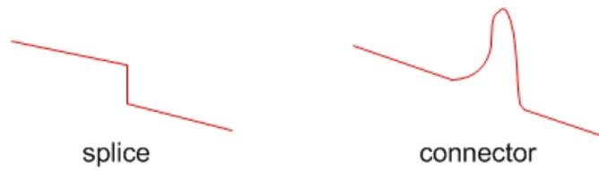
Conectores y empalmadores en un diagrama OTDR.
