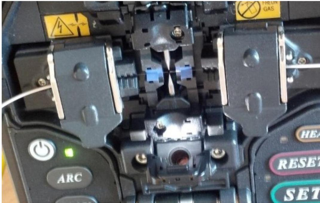
Empalmador con fibras colocadas cerca de los electrodos en el centro, sujetos por abrazaderas de muelle.
