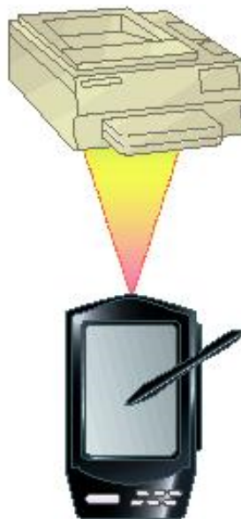
Obr. 1.3 Komunikace IrDA mezi palmtopem PDA a tiskárnou (typ bod-bod)
