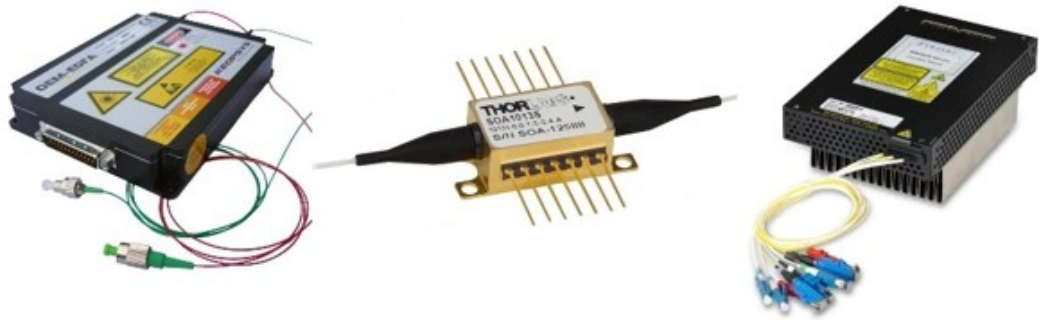
Komerčne dostupné EDFA, SOA a Ramanove zosilňovače.
