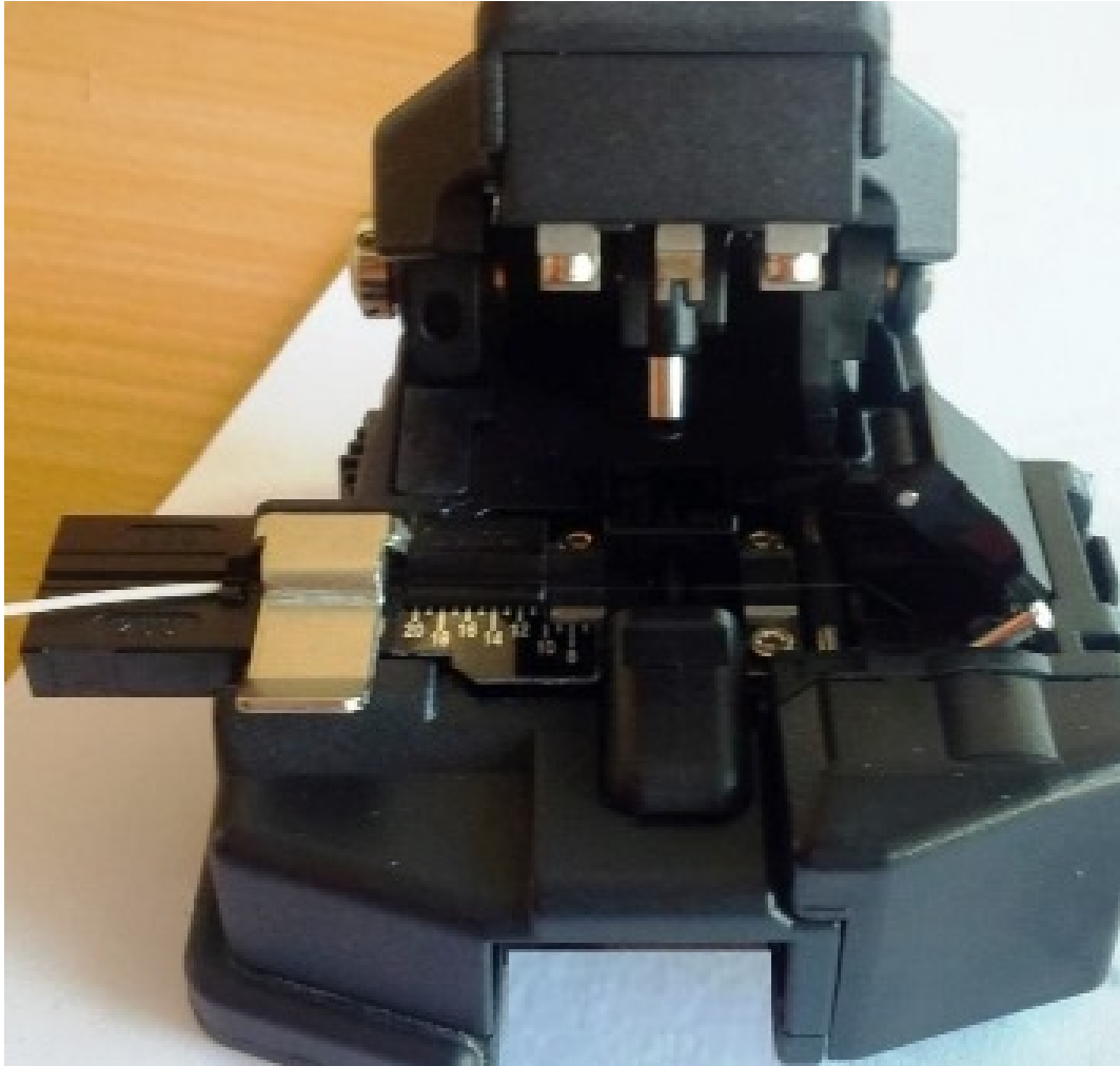
Zalamovačka s vláknom pripraveným na zalomenie.
