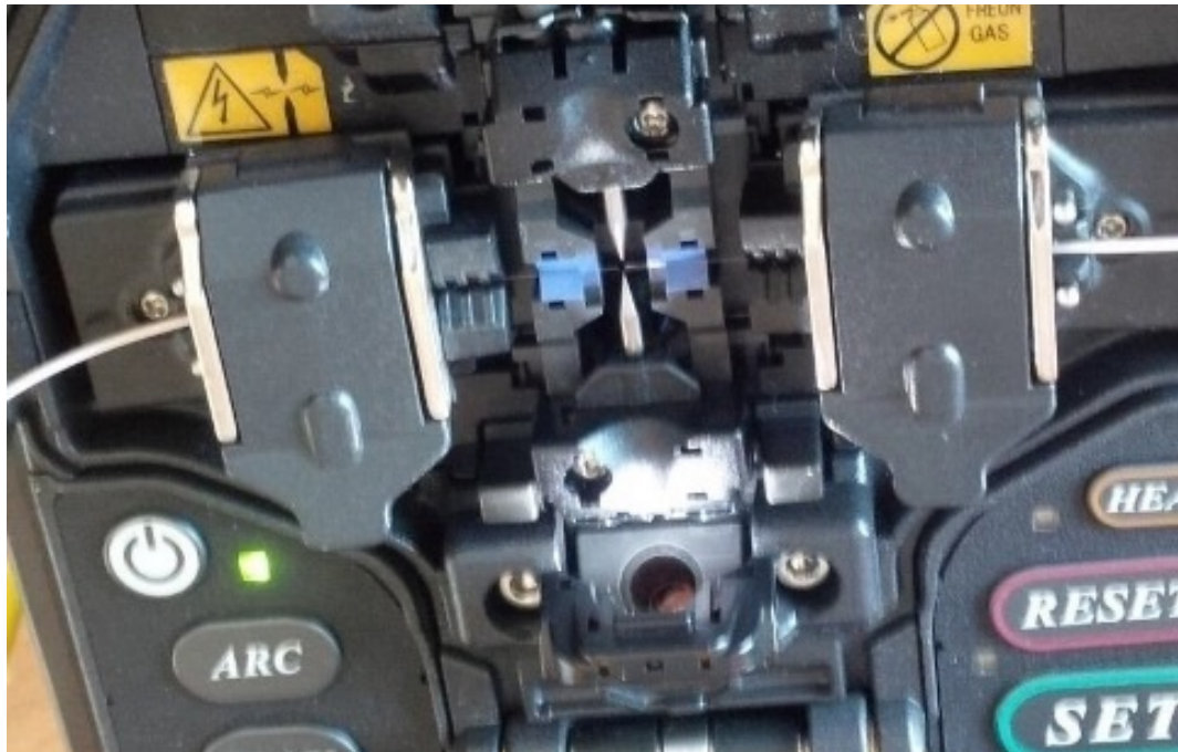
Zváračka s optickými vláknami umiestnenými čo najbližšie ku zvaracím elektródam v strede, pridržiavanými pomocou odpružených svoriek.
