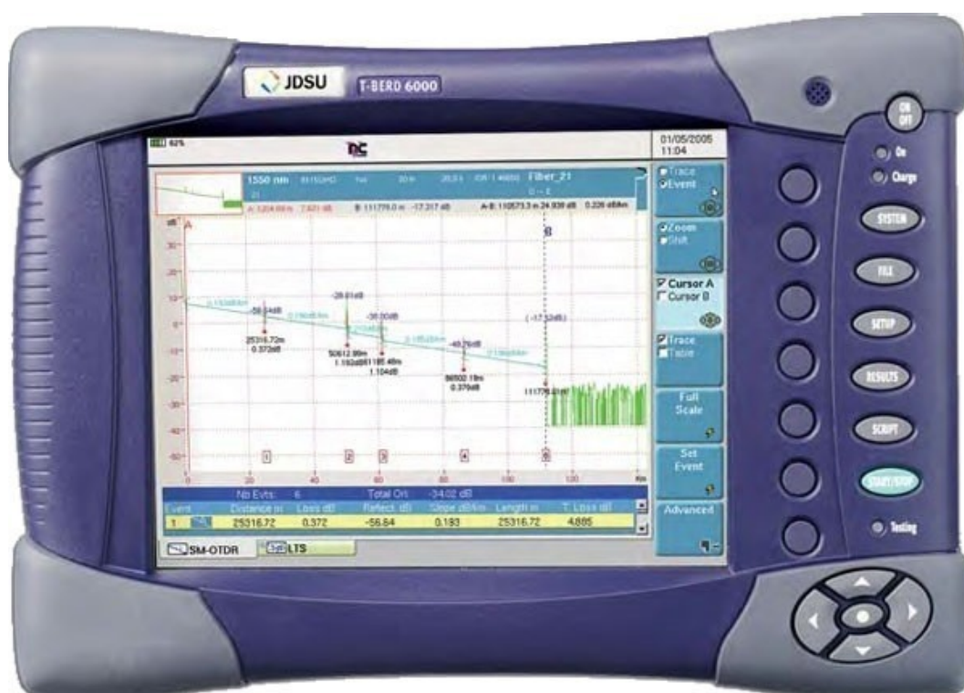
Reflektometr OTDR (Optical Time Domain Reflectometer).
