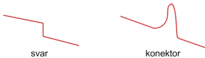
Konektory a svary zobrazené na OTDR.
