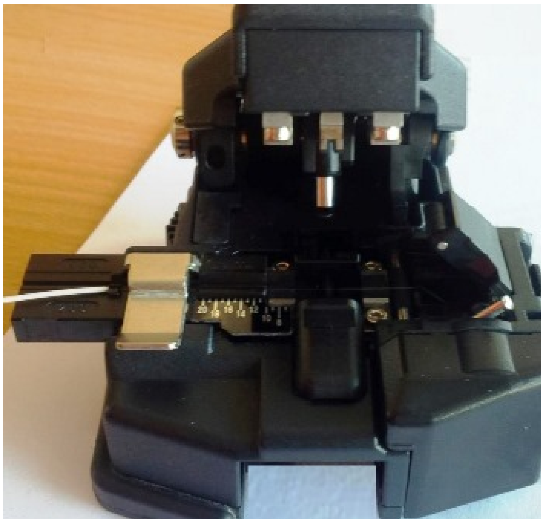
Zalamovačka s vláknem připraveným k zalomení.
