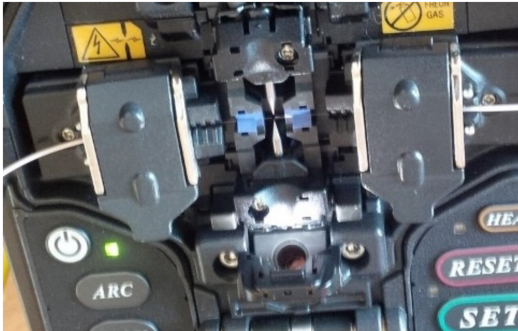
Svářečka s optickými vlákny umístěnými co nejbližše svařovacích elektrod uprostřed; pružinové přichytky je drží na místě.
