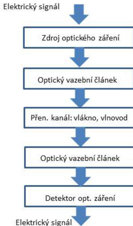
Obr. 5. Blokové schéma optického komunikačního systému.
